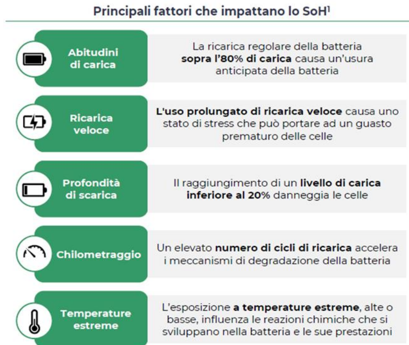
Figura 29. Fattori di utilizzo che hanno una incidenza sulla vita della batteria in uso automotive.
