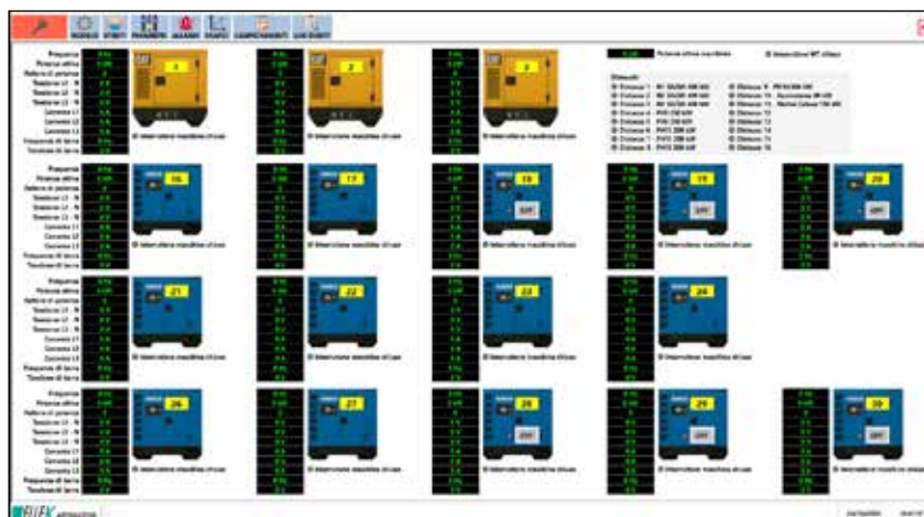
Gestione energia da gruppi elettrogeni (ElleK Automazioni)
