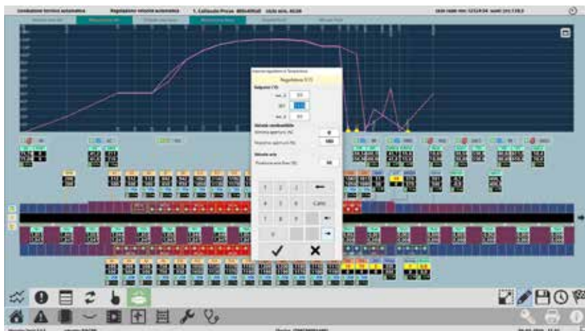
FMJ "diffuso". Valvola aria fissa apertura 50% (SACMI)
