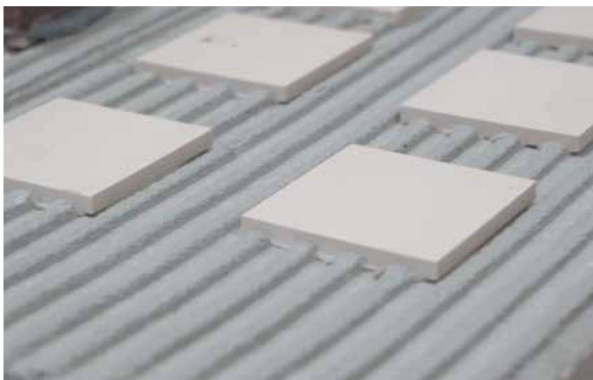
Fig 1- Piastrelle 50 mm x 50 mm posate sull'adesivo cementizio per la prova di strappo (norma EN 12004-2:2017)
