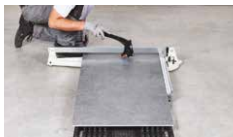
PER SOSTENERE PIASTRELLE DI GRANDE FORMATO DURANTE IL TAGLIO CON TAGLIAPIASTRELLE
