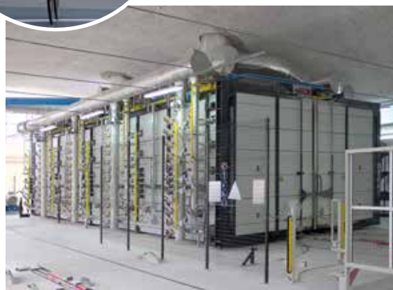
Impianto robotizzato e forno intermittente SACMI (2015)
