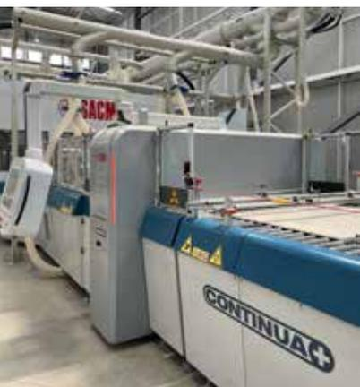
Oltre a Continua+ il progetto ha incluso la fornitura di tutti i sistemi di movimentazione, mentre a valle del compattatore sono stati installati i nuovi sistemi di visione Optima+ e MDX, per un controllo completo delle caratteristiche tecniche, dimensionali ed estetiche della lastra in uscita dal compattatore. Anche l'essiccatoio SACMI esistente è stato potenziato, mentre l'intera linea andrà ad alimentare il forno digitale FMD Maestro.
