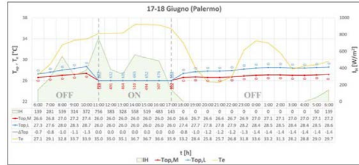
Sperimentazione reale UNIVPM, CiL191 => struttura fortemente inerziale, in estate, riesce a garantire temperature interne più basse , migliorando così il comfort termico.
